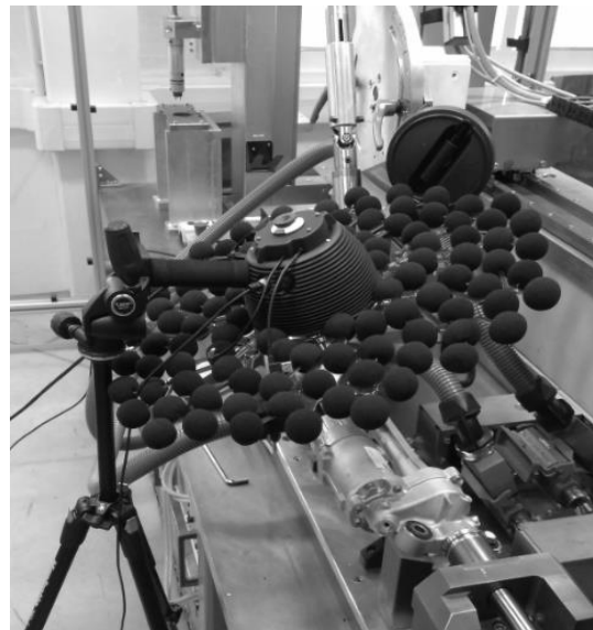
Obrázok 2 – Akustické kamery firiem SIEMENS a CAE Software und Systems.
