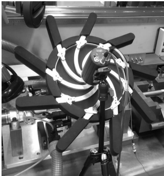
Obrázok 2 – Akustické kamery firiem SIEMENS a CAE Software und Systems.
