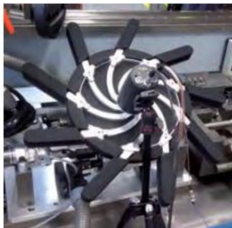
Obr. 5 Lokalizácia zdrojov zvuku pomocou akustickej kamery
