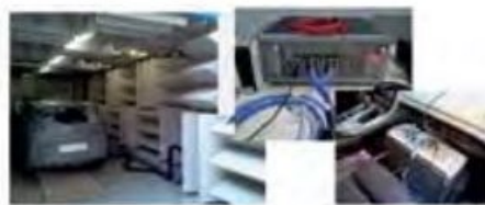
Obr. 5 Príprava na meranie vozidla v polo-bezdzukovej komore (TPA analýza)
