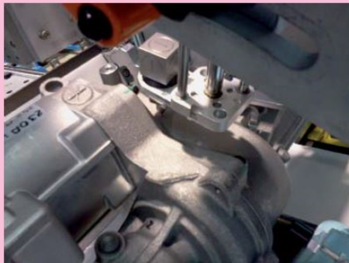
Detail snímača zrýchlenia v kontakte s povrchom kontrolovaného systému
